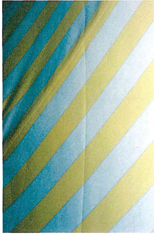
Bild 9.1.18 Technisch bedingte Handlingsfalten bei Transport oder Montage von größeren Markisentüchern. Ursache: Tuch muss zur Montage oder Transport gefaltet werden
